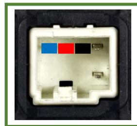
Подключить отдельный длинный зелёный провод эмулятора в пин №7 диагностического разъёма автомобиля (OBD II)
