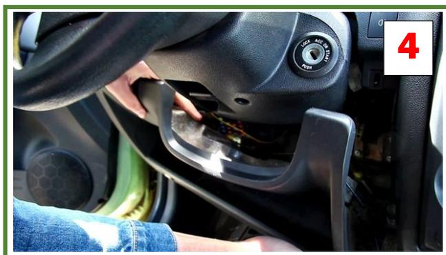
На рулевой колонке найти блок Smartra, отсоединить от него разъём с проводами.
