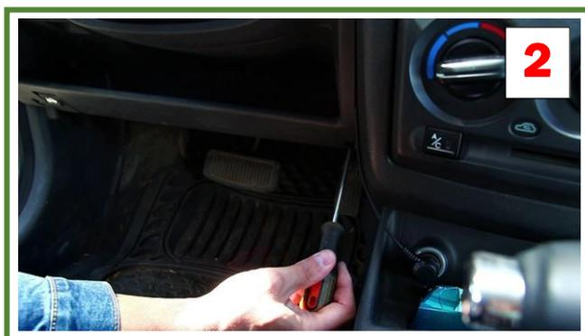
1 болт на 10 под крышкой предохранителей, и снять панель:
